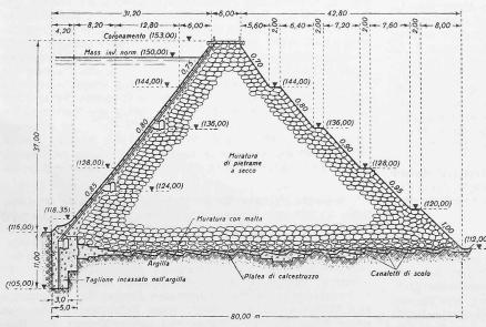
Bild 2. Querschnitt 1:800 durch den Damm aus Trockenmauerwerk,
