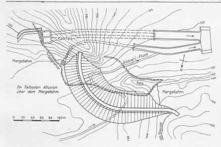
Bild 1. Steindamm bei Gela, Lageplan 1:4000.
