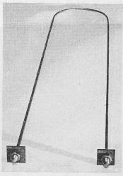
Bild 13. Einseitige Schlaufenverankerung
