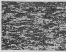
Bild 14. Mikrogefüge des patentierten, gezogenen Stahldrahtes
