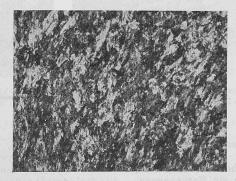
Bild 15. Mikrogefüge im aufgestauchten Kopf des pat., gez. Stahldrahtes Bilder 14 bis 16: Draht horizontal liegend
