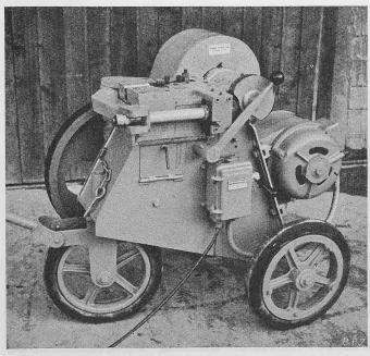
Bild 5. Elektrisch angetriebene Kopfstauchmaschine
