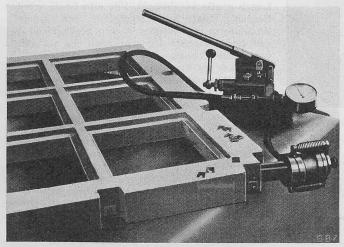
Bild 34, Vorgespannte Betonfenster. Vorspannung der Fenstersprossen mit bituminierten Einzeldrähten  $\phi$  6 mm, Vorspannkraft 3,0 t. Vorspannung in zwei zueinander senkrechten Richtungen. Ausführung: Stahltonwerk Bern AG.
