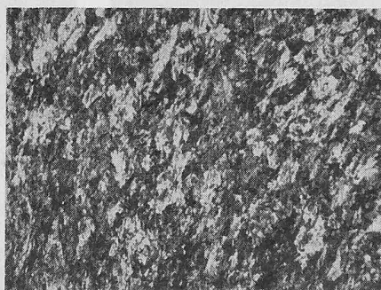
Bild 15. Mikrogefüge im aufgestauchten Kopf des pat., gez. Stahlhahnes
