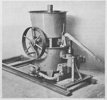
Bild 8 Injektionsgerät
