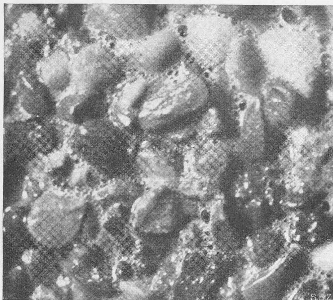
Bild 5. Frisch angemachter Luftporenbeton, Vergrößerung 1:100
