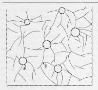
Bild 6. Struktur des Zementsteins im Luftporenbeton; a Luftporen, b Kapillarporen
