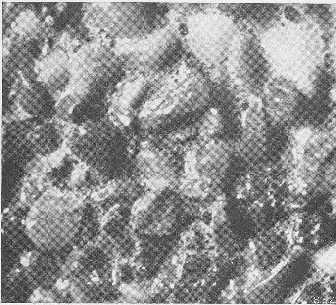
Bild 5. Frisch angemachter Luftporenbeton, Vergrößerung 1:100
