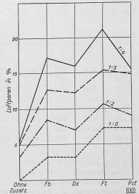
Bild 7. Luftporeneinführung in vier verschieden fette Mörtel (1:0 bis 1:4), ohne Zusatz und mit vier verschiedenen Zusätzen
