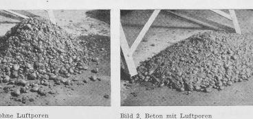
Bild 1. Beton ohne Luftporen
