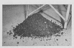
Bild 3. Kies-Sand ohne Luftporen
