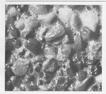
Bild 5. Frisch angemachter Luftporenbeton, Vergrösserung 1:100
