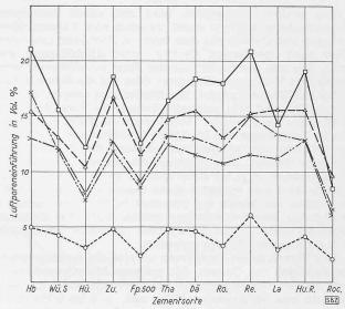
Bild 9. Luftporenbildung in Mörteln, die mit verschiedenen Zementsorten hergestellt wurden. Unterste Kurve: Zemente ohne Zusätze; obere Kurven: Zemente mit vier verschiedenen Zusätzen (Legende links neben dem Bild)
