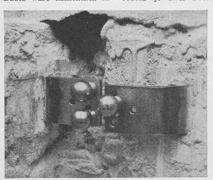
Bild 19 Die fertig versetzten Messkugeln
