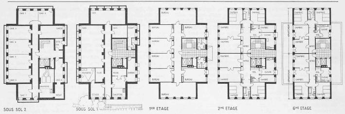
Bilder 3 bis 7. Grundrisse des Baues 3 an der Rue de Tivoli, 1:500
