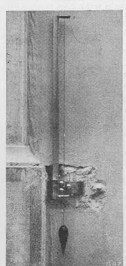
Bild 18. Justieren der Messkugeln
