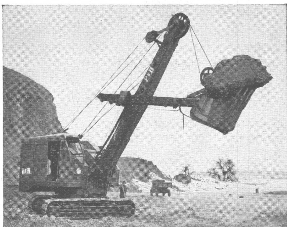
Löffelbagger mit Tru-Lay-Brugg-Drahtseilen ausgerüstet
