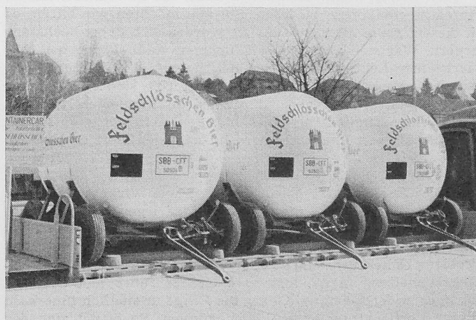
Bild 9. Die «Feldschlösschen»-Behälter werden an Seitenrampen auf gewöhnliche Plattformwagen verladen.
