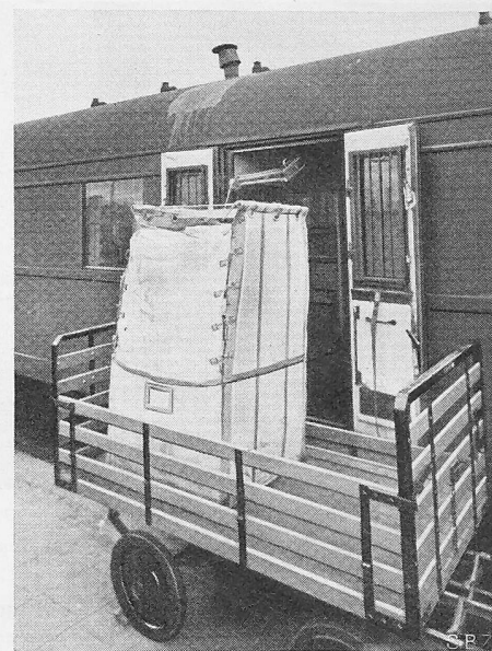
Bild 17. Durch die Einführung von Post- und Gepäckbehältern können die Aufenthalte der Züge auf Unterwegsbahnhöfen verkürzt werden.
