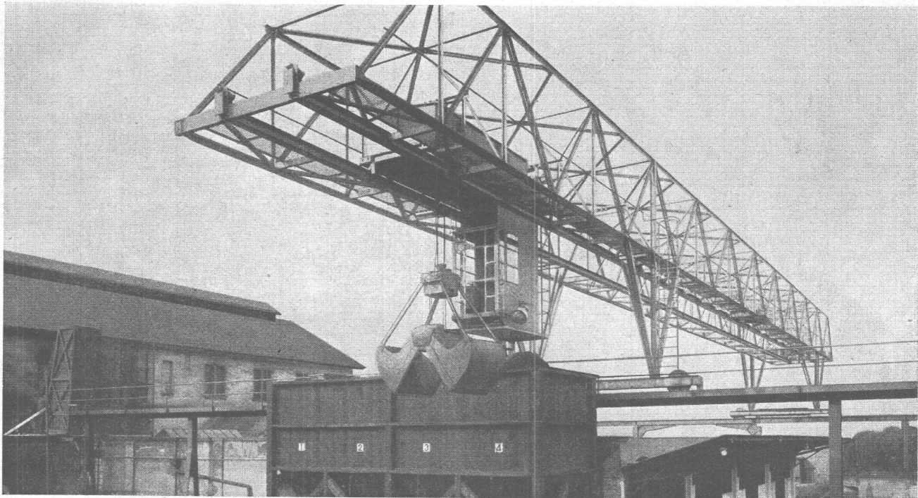
Verladebrücke in Schweisskonstruktion 2,5 t Tragkraft, 46 m Länge
