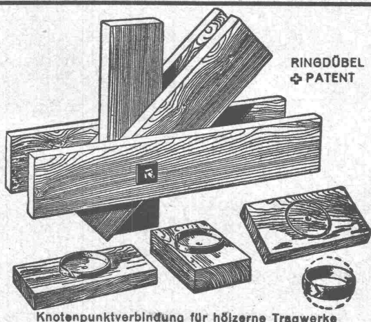
Knotenpunktverbindung für hölzerne Tragwerke
