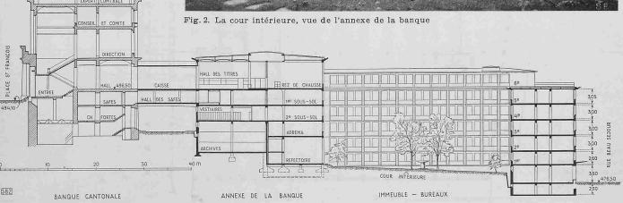
Fig. 3. Coupe à travers les trois groupes: banque, annexe et bureaux locatifs. Echelle 1:700
