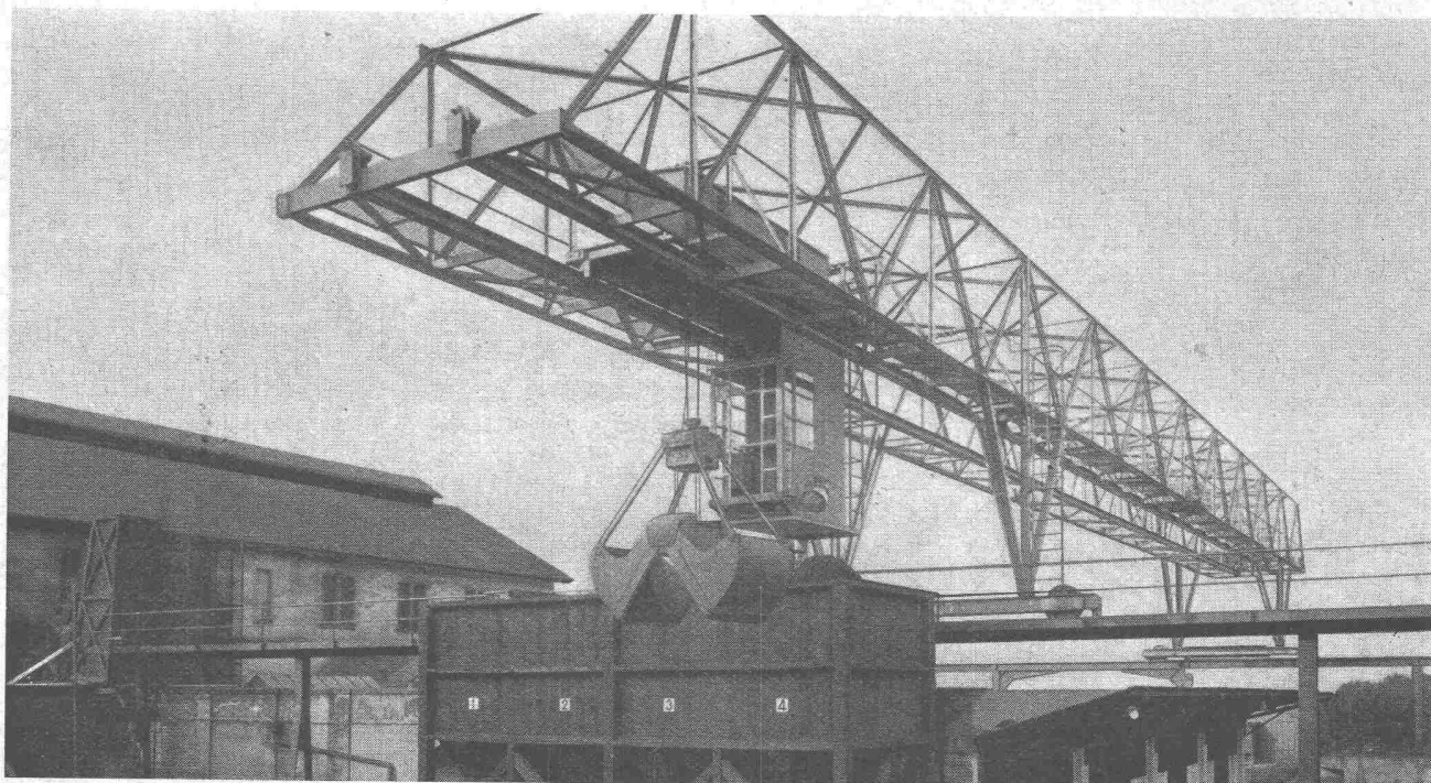
Verladebrücke in Schweisskonstruktion 2,5 t Tragkraft, 46 m Länge
