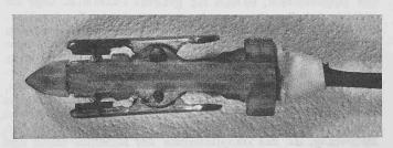
Bild 9. Doppelklammer für die Zuleitungsdrähtchen von Dehnungsgebern (Naturgrösse)
