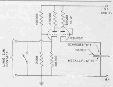
Bild 17. Prinzipschema der Schaltung mit elektronischem Relais für Aufzeichnungen auf Teledeltos-Papier mittels elektrischer Stifte. Ein Pol des auf der Maschine angeordneten Kontakts und die Schreibplatte sind geerdet. Wenn der Kontakt offen ist, beträgt die Spannung zwischen den beiden Polen nur 30 Volt
