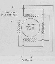
Bild 14 (rechts). Schaltschema für den Gebrauch eines Wirbelstrom-Motors als Rotationsbeschleunigungs-Geber
