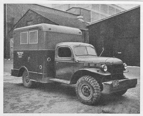
Bild 15. Lastwagen mit eingebauter Instrumenten-Anlage
