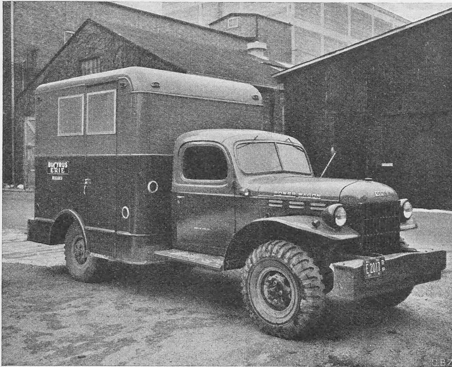
Bild 15. Lastwagen mit eingebauter Instrumenten-Anlage
