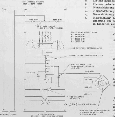
Bild 1. Prinzipschema einer Messbrückenschaltung mit fünf Eichstufen
