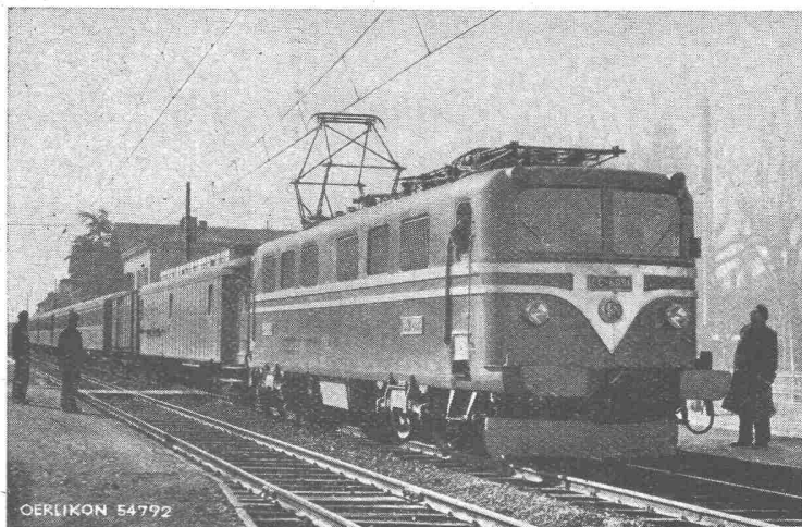
CoCo-Lokomotive No. 6051 der Société Nationale des Chemins de fer Français (S. N. C. F.) für Einphasenstrom 50 Per./s, 20 KV, Stundenleistung 4300 PS, mit Schnellzug auf der Strecke Aix-les-Bains—Annecy. Diese Lokomotive hat bisher 120 000 km zur vollen Zufriedenheit der S. N. C. F. bewältigt.
