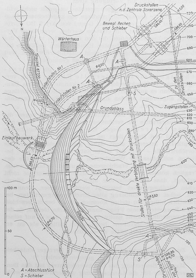
Bild 20. Staumauer Val Gallina, Lageplan, Masstab 1:2500
