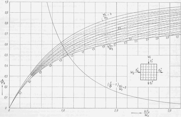
Bild 17.  $\Phi$ -Funktion für Kreuzstrom
