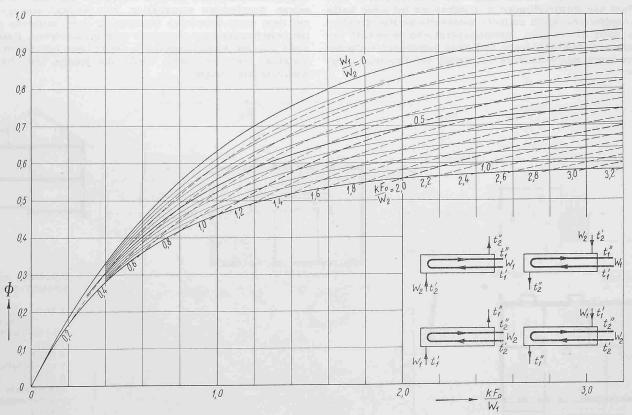
Bild 18.  $\Phi$ -Funktion für Haarnadeleinsatz (Zweigangeinsatz), Aussenstrom quergerührt. Das Diagramm ist für alle vier dargestellten Varianten streng gültig
