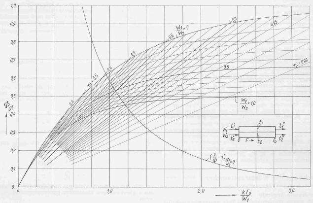
Bild 15. Φ-Diagramm für Gleichstrom
