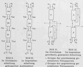
leitungen). Wir wenden hier die «Schnittmethode» an, indem wir um einzelne Teile geschlossene Schnitte legen (siehe z. B. Teil c in Bild 9) durch die jeweils zwei (und nur zwei!) eintretende und zwei austretende Ströme geschnitten werden.
