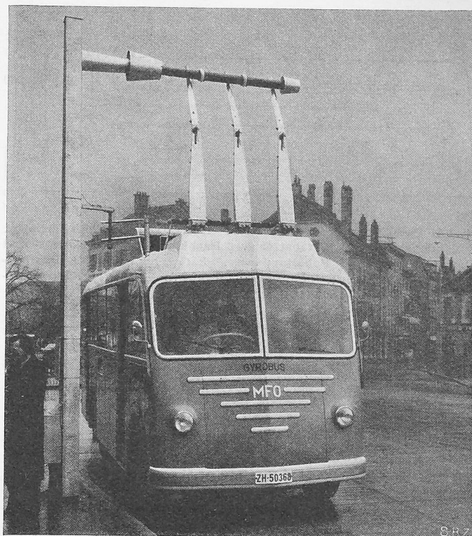
Bild 10. Gyrobus an der Energietanksäule
