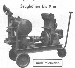
Leistungen 1—500 I/sek. Kein Bodenventil. Keine Klappe im Saugstutzen. Keine Hilfs-Vakuum-Pumpe. Jederzeitiges automatisches Ansaugen auch nach Luffeintritt im Saugrohr. Keine reibenden, sich abnützenden Dichtungsflächen, daher störungsfrei auch bei Schlamm-, Sand- und Kiesförderung.
