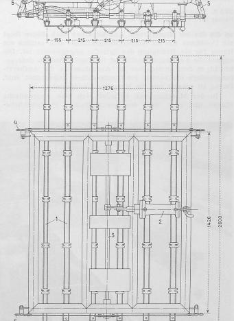
Bild 6. Wellapparat, Masstab 1:20 1 Saugkammern, 2 Servomotor, 3 Welle, 4 und 5 Hebelwerk
