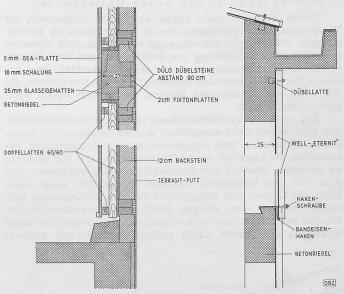
Bild 10. Einzelheiten der Wandkonstruktionen, links für die geheizte Fabrikationshalle, rechts für das Materiallager; Masstab 1:30
