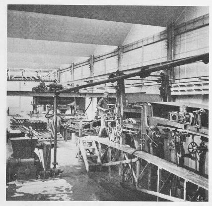
Bild 2. Plattenmaschine (links) und Abhebevorrichtung (hinten). Rechts vorn der Weichabfall-Auflöser
