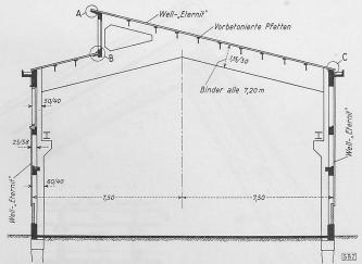
Bild 9. Querschnitt durch das Materiallager, Masstab 1:200
