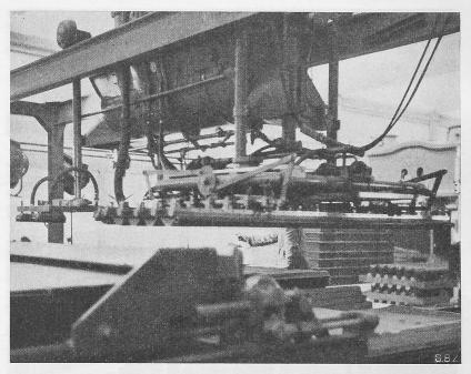
Bild 5. Abhebevorrichtung mit Wellapparat
