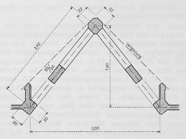
Bild 2. Querschnitt 1:60 durch Oberlicht
