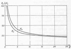
Bild 2. Vorausberechnete Schwankungsverhältnisse für grössere Relativwerte der Anlagegrösse
