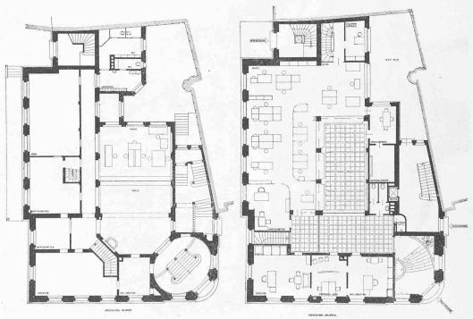
Bild 2. Erdgeschoss vor dem Umbau 1:350 Bild 3. Erdgeschoss nach dem Umbau Solothurner Handelsbank. Umbau des Hauptsitzes durch Arch. OTTO SPERISEN, Solothurn
