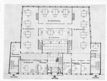
Bild 10. Erdgeschoss 1:350 gemäss Wettbewerbs-Entwurf
