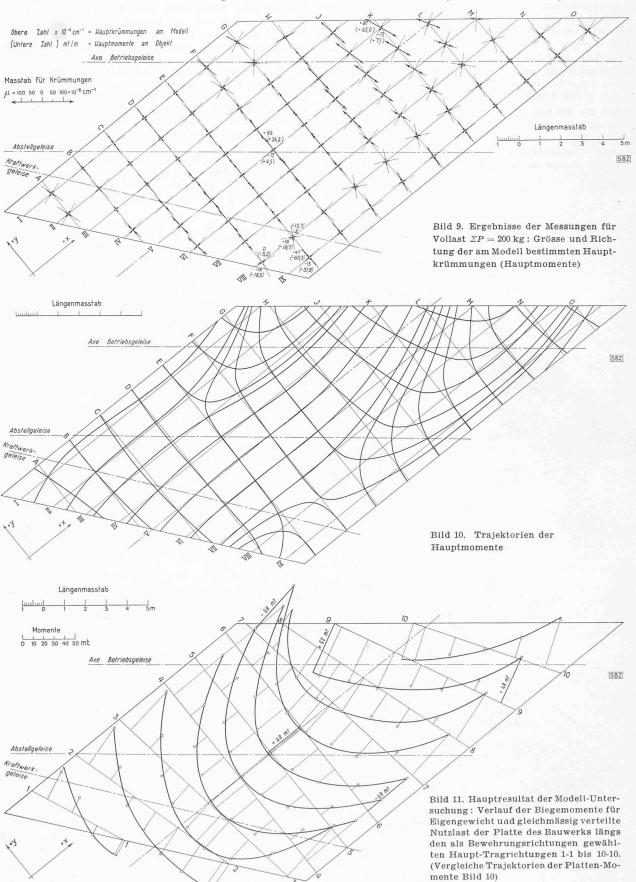
Die Streuungen der Festigkeitswerte sind von geringer, praktisch bedeutungsloser Grösse. Um einen ausreichenden Sicherheitsgrad gegen Bruch des spröden Materials einzuhalten, wurde die zulässige Spannung zu 8 kg/cm² gewählt und die Belastung des Modells dementsprechend begrenzt.
