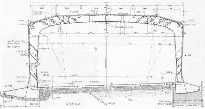
Bild 14. Querschnitt des Bauwerks, Masstab 1:80, mit Armierung
