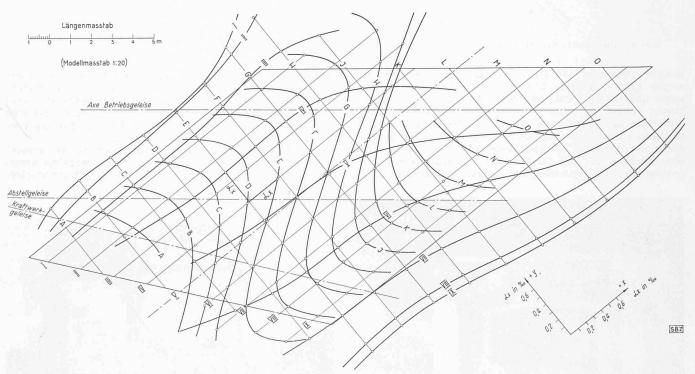
Bild 7. Gemessene Drehungen  $\alpha_x$  der Spiegel, Verlauf über die Platte des Modells. Belastung :  $\Sigma P = 200$  kg, gleichförmig verteilt
