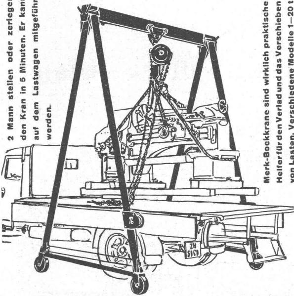
Merk-Bockkrane sind wirklich praktische Heizer für den Verkauf und das Verschieben von Lasten. Verschiedene Modelle 1-20 t Tragkraft verschiedener Höhen und Breiten. Verlangen Sie nähere Angaben.
