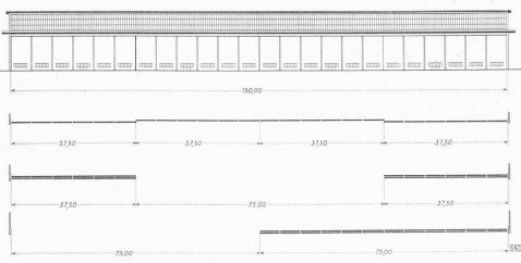
Bild 8. Schiebetor der Werfthalle Kloten, Uebersicht möglicher Torstellungen 1:1200
