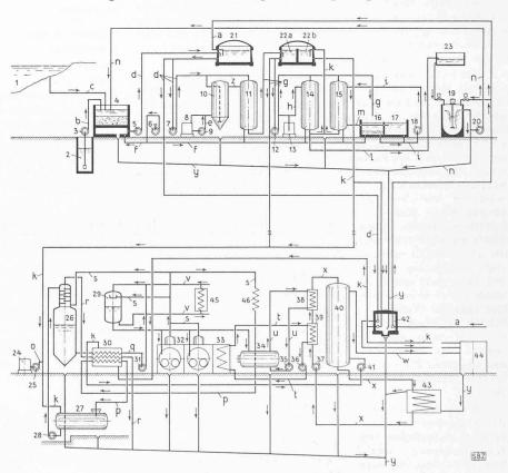
Bild 1. Prinzipschema der Wasser-Reinigungsanlage
