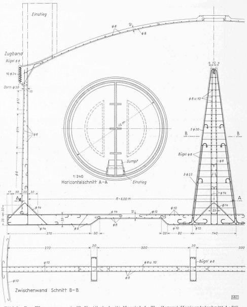
Bild 6. Das Wasserreservoir 22, Vertikalschnitt Masstab 1:60; Gesamt-Horizontalschnitt 1:240
