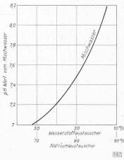
Bild 5. Zusammenhang zwischen pH-Wert und Mischungsverhältnis der Wässer aus Wasserstoff- und Natriumaustauscher
