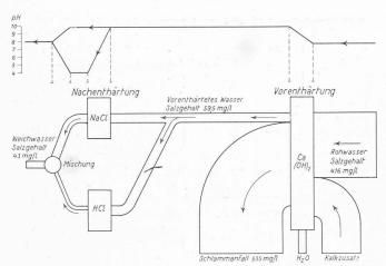
Bild 4. Diagramm des Salzgehaltes und Verlauf des pH-Wertes
