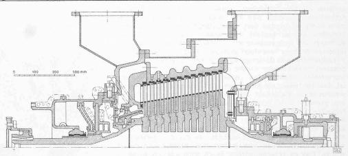
Bild 21. Geschweisste Rotorkonstruktion einer amerikanischen Gasturbine, Masstab 1:12.5 [8]
