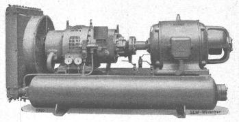
Luftgekühlter SLM-Chassis-Kompressor, Leistung 35 PS
