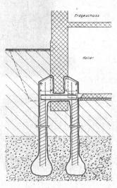
Unterfangung mit Betonbohrpfählen
