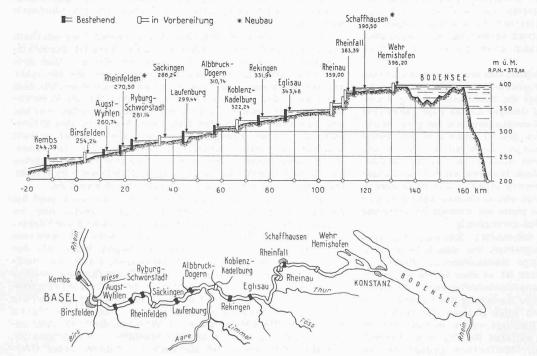
Bild 7. Ausbau der Rheinstrecke Basel-Bodensee; Plan 1:1500000, Längenprofil 1:1500000, Höhen 1:7500
