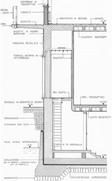
Bild 17. Warenhaus Innovazione in Chiasso. Schnitt durch Keller (Dekorationsgang) und Erdgeschoss (Schaufenster), Masstab 1:60
