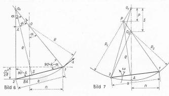
Der Drehzapfenabstand a ist sehr klein gegenüber dem Krümmungshalbmesser R. Wird weiter berücksichtigt, dass erst bei vollzogenem Einlauf  $\lambda = \alpha/2$ , vorher aber stets  $\lambda < \alpha/2$  ist, so kann tg  $\alpha$  tg  $\lambda$  vernachlässigt werden, und man erhält aus Gl. (1)
