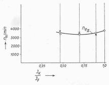
Bild 30. In der Breite verjüngte Stäbe: Abhängigkeit der II. Eigenfrequenz vom Verjüngungsverhältnis  $J_k/J_F$  ( $J_K$  Trägheitsmoment des Kopfquerschnittes),  $J_K$  Trägheitsmoment des Fussquerschnittes), O unverwunden, nach Versuch,  $\times$  um  $45^{\circ}$  annähernd gleichmässig verdrillt nach Versuch,  $\triangle$  unverwunden mit 0.43 l nach Rechnung
