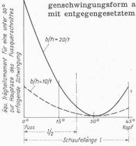
Bild 24. Abhängigkeit des für die mittlere Schwingungsrichtung massgebenden äquatorialen Trägheitsmomentes vom Abstand des betreffenden Querschnittes vom Fuss bei schlanken Profilen
