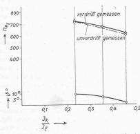
Bild 29. Abhängigkeit der I. Eigenschwin-3gungszahl u. der Verschiebung  $\delta$  der Schwingungsrichtung gegenüber der Hauptträgheitsaxe des Fussquerschnittes bei in der Breite verjüngten Stäben vom Verhältnis der Trägheitsmomente  $J_K$  und  $J_F$  am Kopf und am Fuss
