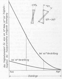
Bild 27. Aquatoriales Trägheitsmoment für eine um 150 bzw. 450 zur Trägheitshauptaxe des Fussquerschnittes erfolgende Schwingung
