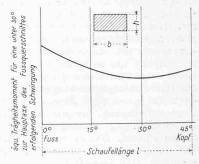
Bild 25. Abhängigkeit des für die mittlere Schwingungsrichtung massgebenden Trägheitsmoments vom Abstand des betreffenden Querschnittes vom Fuss beim gedrungenen Profil b/h=2/1
