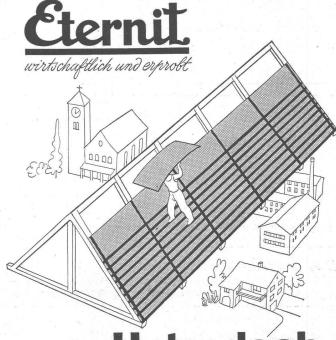
Die auf den Sparren verlegten Platten bilden ein Unterdach, welches besten Schutz vor eindringender Nässe, Flugschnee, Staub, sowie Feuerübergriff gewährleistet. Die grossformatigen und leichten Platten gestatten eine einfache und rasche Verlegung.
