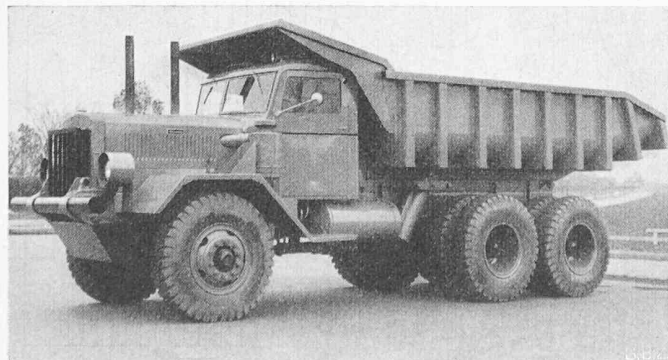
Bild 6. Amerikanischer Erzwagen für 20 t Nutzlast
