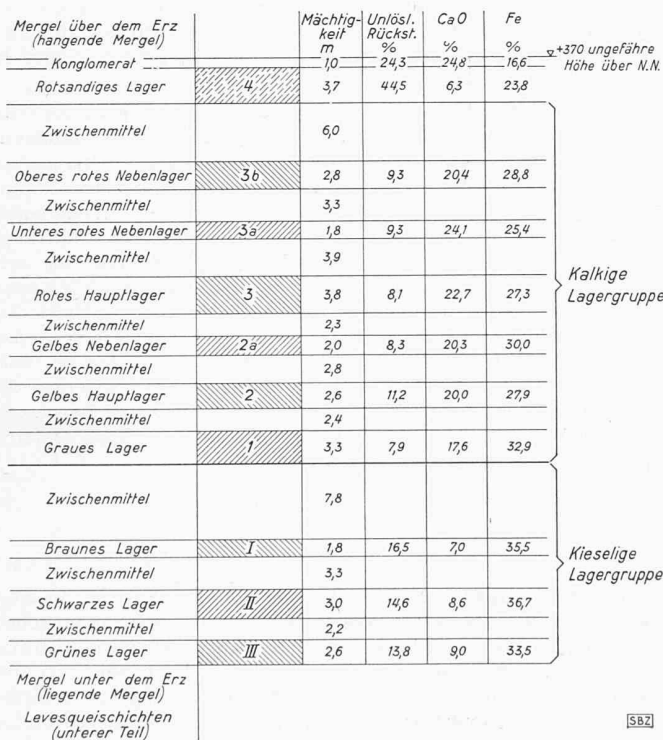
Bild 2. Schematischer Vertikalschnitt durch die Luxemburger Eisenerzformation im Graben von Esch
