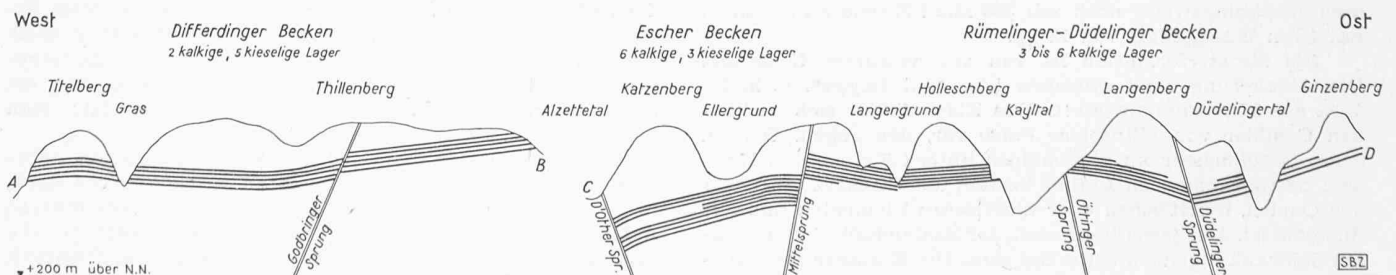
Bild 3. Längsschnitte durch die Eisenerzformation Rodingen-Esch-Düdelingen (nach Dr. M. Lucius), Längen 1:100 000, Höhen 1:10 000
