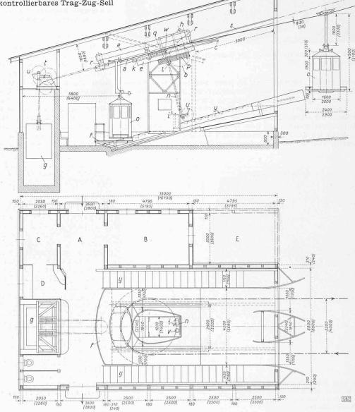
Endstationen werden gleichzeitig durch kurzes Anhalten der ständig am Seil verbleibenden Kabinen bedient, die auch in Umsteigstationen keine Wartung erfordern.
