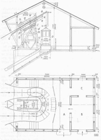
Bild 2. Bergstation mit Antrieb, Masstab 1:150
