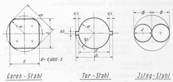
Bild 2. In der Schweiz gebräuchliche Sonderstahlsorten für Eisenbetonbau
