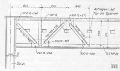
Bild 5. Verstärkung bei Bindern mit ausgebeulten Stehblechen, 1:50
