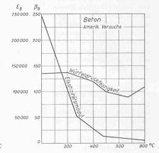
Bild 1. Abhängigkeit der Festigkeitszahlen von der Temperatur
