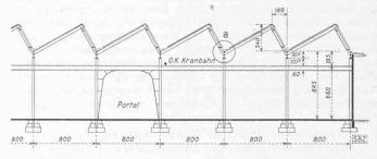
Bild 3. Längsschnitt 1:500, Detail a siehe Bild 4
