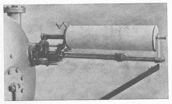
Fig. 5. Vue du dispositif d'enregistrement de la course des équipages mobiles
