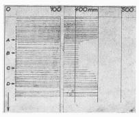
Fig. 11. Diagramme des courses avec déplacement prolongé de la position du point mort extérieur
