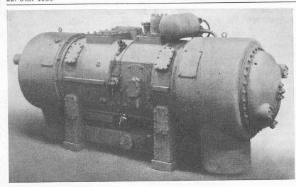
Fig. 4. Vue d'un générateur à pistons libres GS-34
