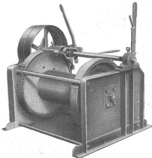
Seilwinden KS für Zugkraft von 1,5 und 2,5 Tonnen
