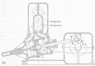
Bild 20. Pumpe mit oszillierendem Zylinder
