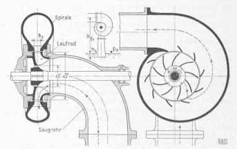
Bild 21. Zentrifugalpumpe
