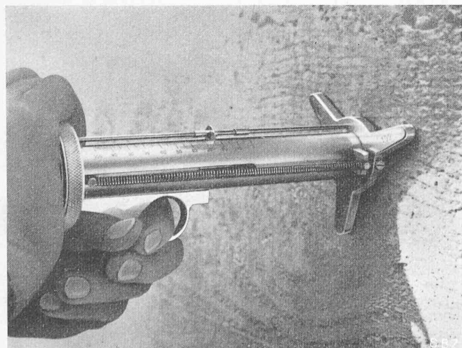
Bild 1. Der Beton-Prüfhammer im Gebrauch
