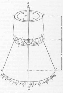
Bild 6. Vorschlag von Leonhard Euler für eine Reaktionsturbine mit Leitrad, aus SBZ Bd. 123, S. 2\*, 1. Januar 1944
