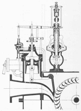
Bild 14. Tangentialrad-Turbine
