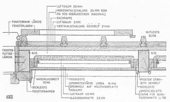
Bild 15. Konstruktionsdetail der Aussenwand. Horizontalschnitt 1:10
