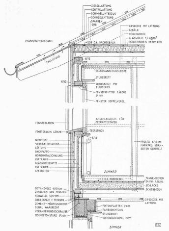
Bild 14. Fassadenschnitt 1:25
