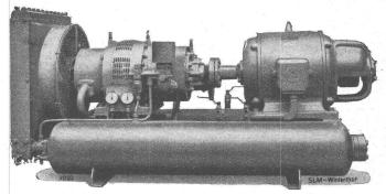
Luftgekühlter SLM-Chassis-Kompressor, Leistung 35 PS
