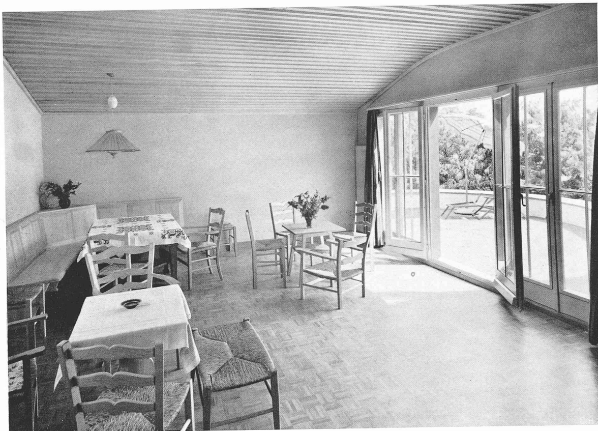
Bild 7. Aufenthaltsraum für Schwestern und Hausangestellte, in Verbindung mit dem windgeschützten Sitzplatz. Wände helle Panzersalubra, Decke tannenes Leistentäfer mit goldgrüner Lasur überzogen
