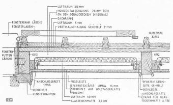
Bild 15. Konstruktionsdetail der Aussenwand. Horizontalschnitt 1:10
