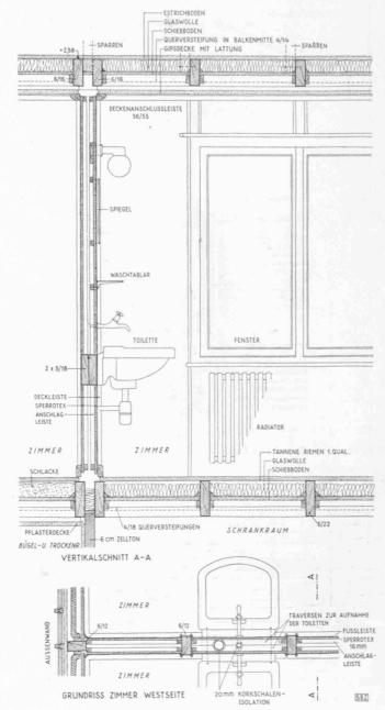
Bild 11. Zwischenwand. Einzelheiten 1:25
