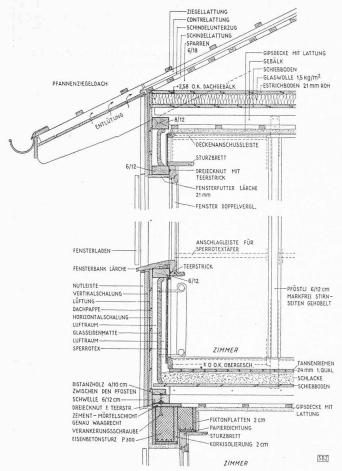
Bild 14. Fassadenschnitt 1:25
