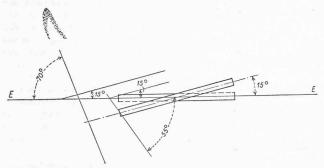
Bild 23. Schwingungsform (links oben, schwach sichtbar) am Schaufelkopf bei einem Seitenverhältnis 20/1 und 15° Verdrillung. Die Erregungsrichtung EE fällt mit der 2. Hauptträgheiteaxe des Fussquerschnittes zusammen. Die Schwingungsform ist keine gerade Linie, sondern eine verwickelte Kurve, deren Hauptrichtung um 40° gegen die 2. Hauptträgheitsaxe verschoben ist.
