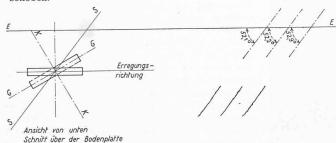
Bild 21. Drei Aufnahmen der Schwingungsrichtung am Schaufelkopf für das Seitenverhältnis  $10/1\,$  und  $30^{\,0}$  Verdrillung. Die Schwingungsrichtung SS ist gegen die Hauptträgheitsaxe des Fussquerschnittes um  $52.4^{\,0}$  verschoben.
