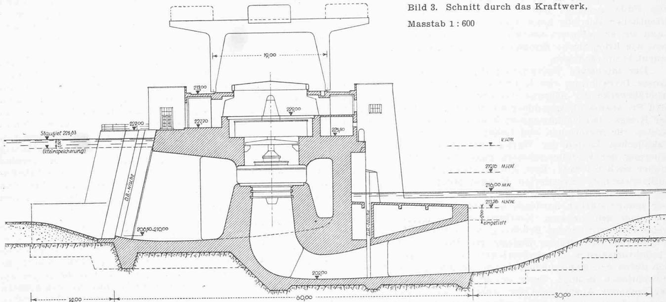
Bild 3. Schnitt durch das Kraftwerk,
